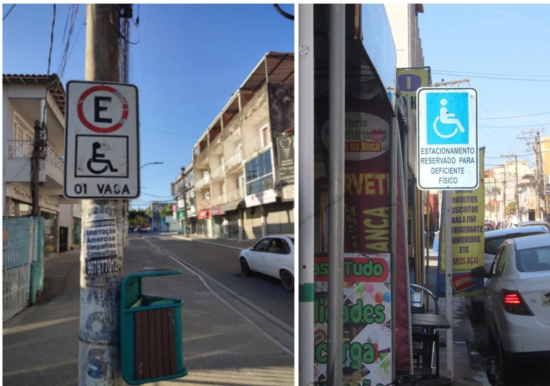
Figura 37 - Sinalização vertical para vaga de estacionamento para pessoas com mobilidade reduzida
