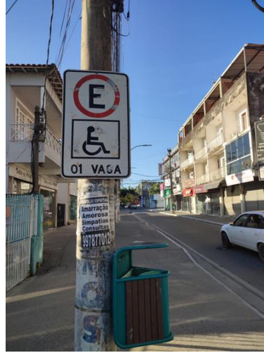
Figura 150 - Sinalização vertical para vaga de estacionamento para pessoas com mobilidade reduzida
